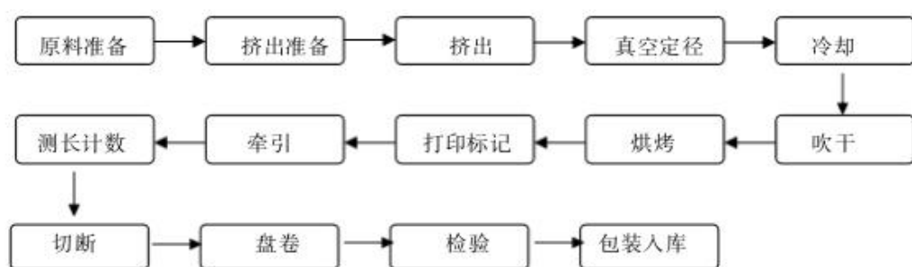
图：PE管道产品生产工艺流程
