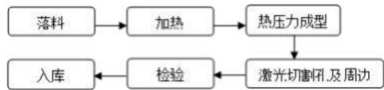
图：汽车热成型件生产工艺流程
