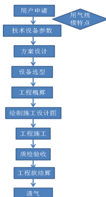
图：燃气工程安装服务流程图
