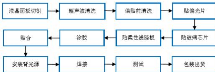
图：中小尺寸触控显示一体化工艺流程图
